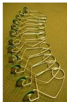
Pour le calage des calottes. En acier ressort, surface d'appui en feutre.
