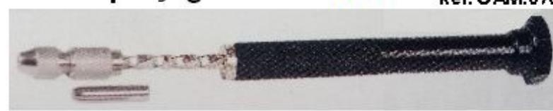
Pour forets de petits diamètres - Capacité de 0 à 0,70 mm - corps en laiton principe d'une vrille sur un ressort permettant le retour automatique ; chaque mouvements = 1,5 tour.
