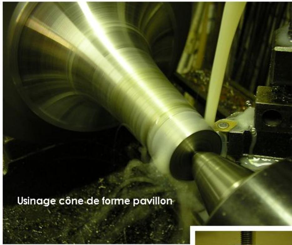
Usinage cône de forme pavillon
