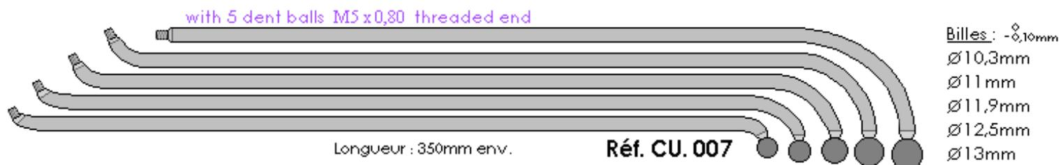
Barres courbes de débosselage pour tubes coudés, coulisses d'accord, ... ; livrées avec 5 billes vissables, taraudées M5 x 0,80
