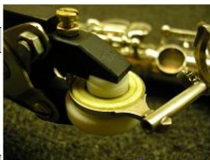
Pince pour sertir les rivets de calottes de Flûtes. Sans endommager, sans déformer par 2 assises en Téflon®PTFE., cette pince parallèle exerce une pression et un sertissage régulier sur le pourtour du rivet. Longueur : 140mm
